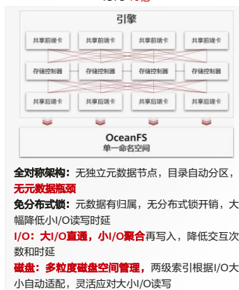
全对称架构OceanFS并行文件系统 单集群可扩展到 4096节点 ，单集群带宽 10 TB/s ， IOPS 10亿
