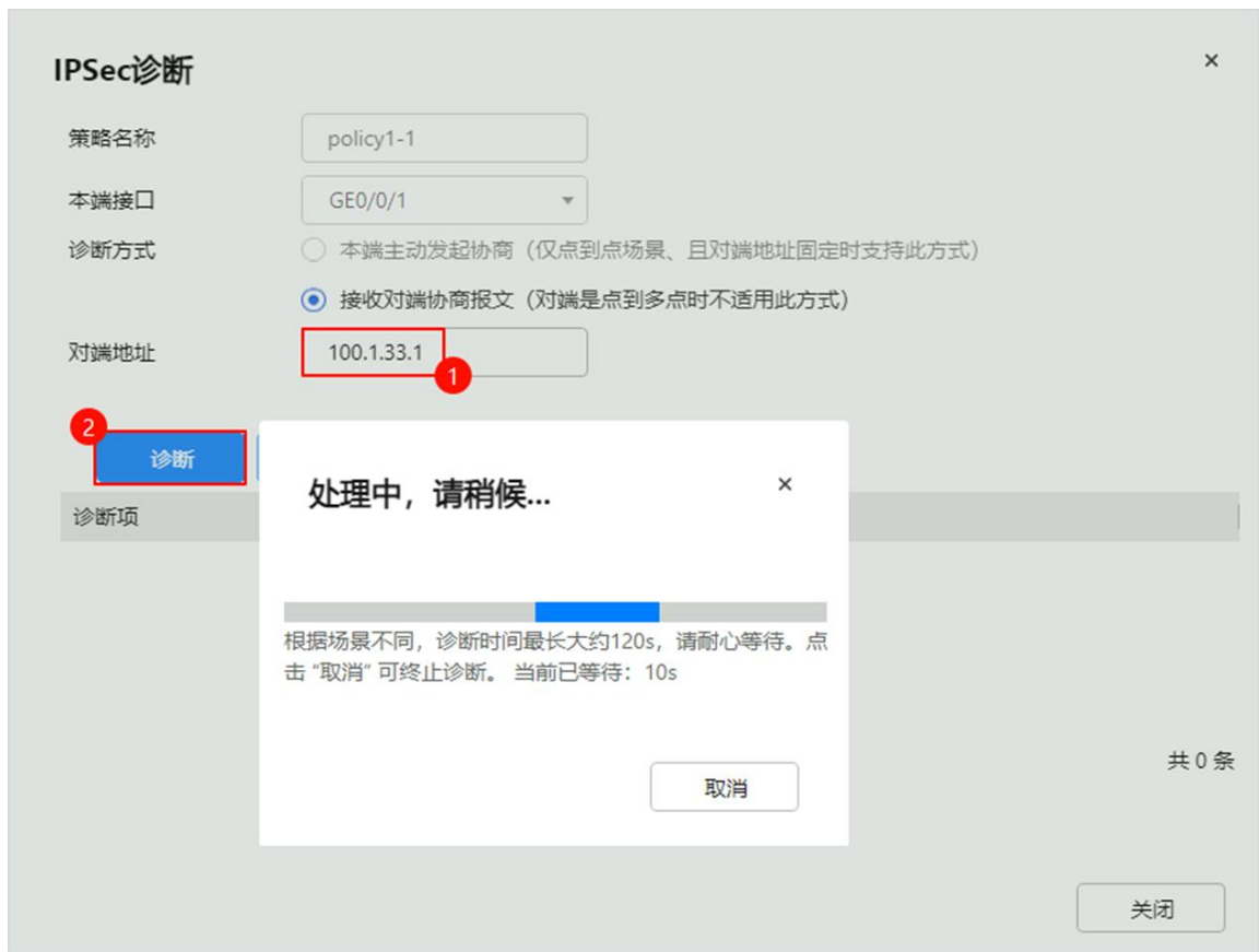
图14-19 开始 IPsec 策略自动化诊断
