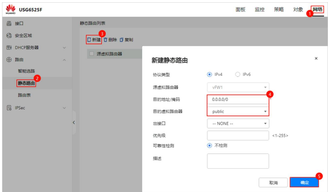
图1-18 创建 vFW1 虚拟系统访问外部的缺省路由
