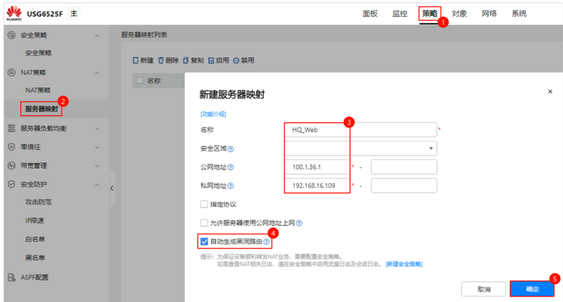
图10-13 HQ-FW1 创建针对企业总部 Web 服务器的 NAT Server
