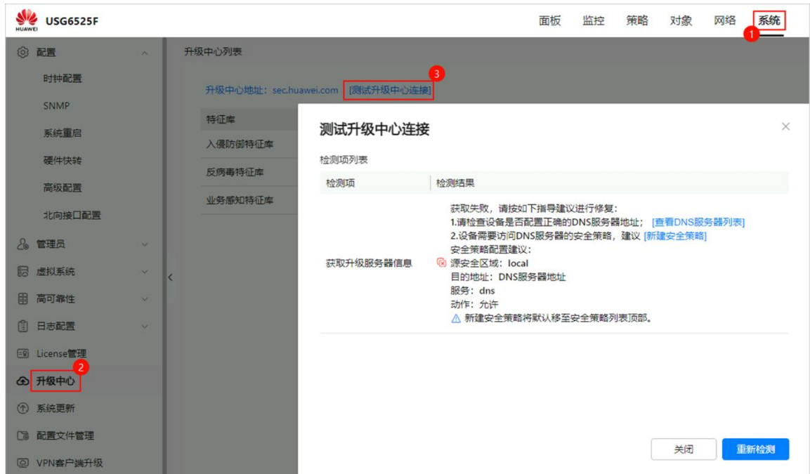
图14-33 测试 DC-FW 设备与升级中心的连通性
