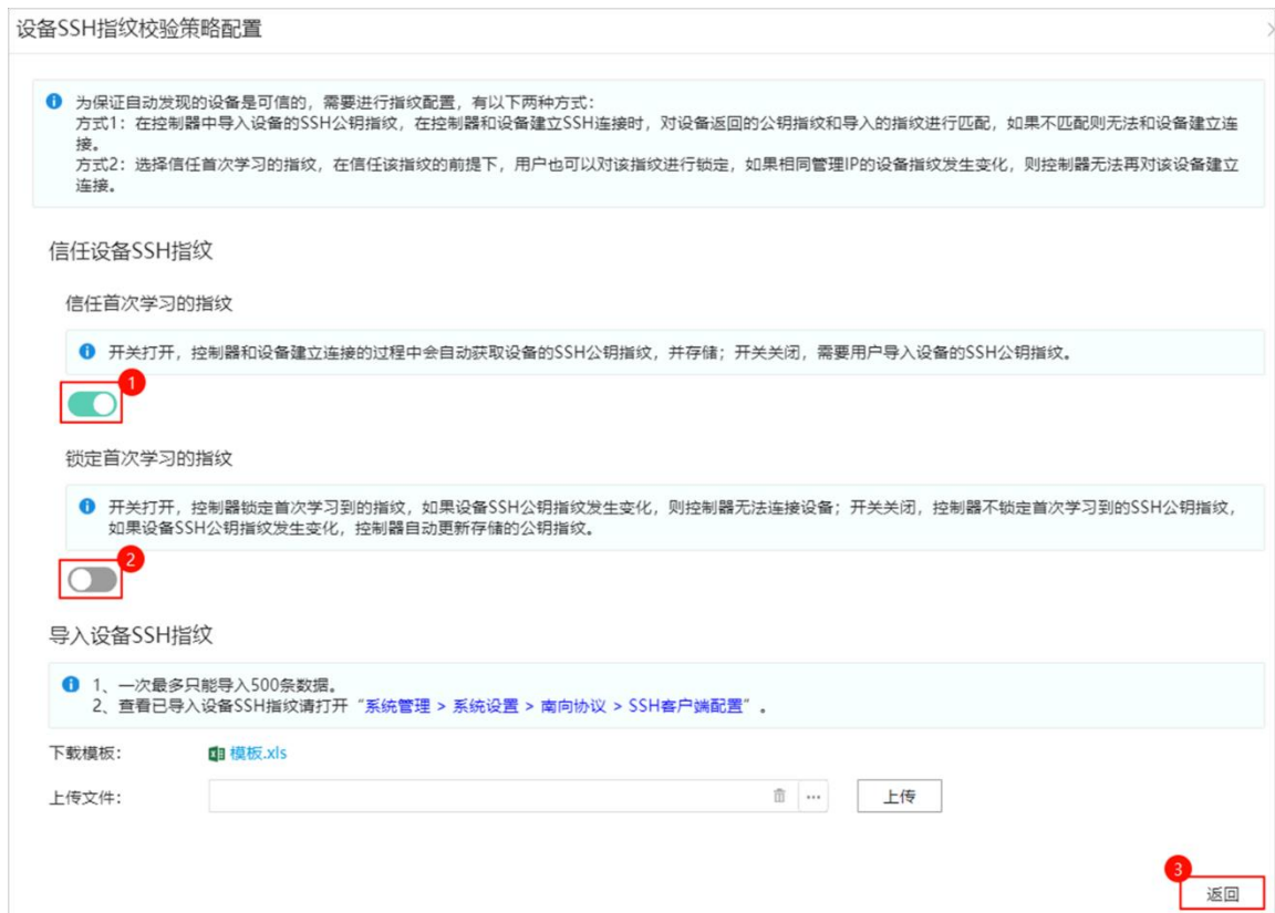
图13-12 配置设备 SSH 指纹校验策略
