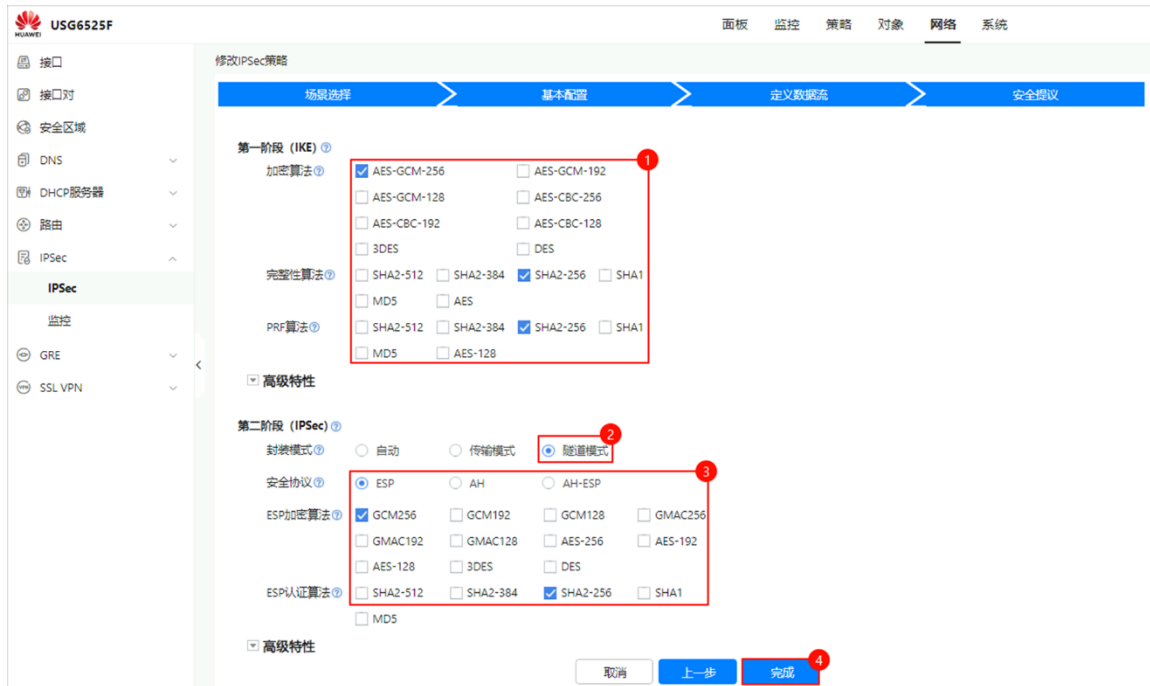
图6-11 配置 IKE 和 IPSec 安全提议并提交 IPSec 策略
