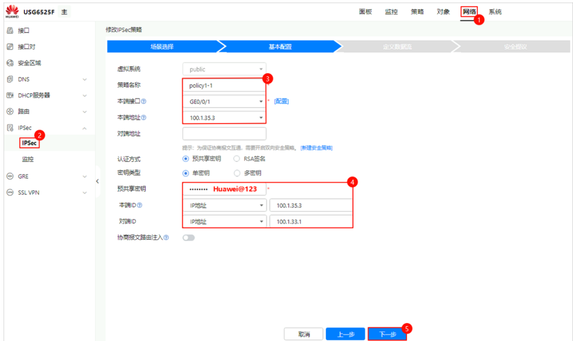
图6-5 IPsec 策略基础参数配置
