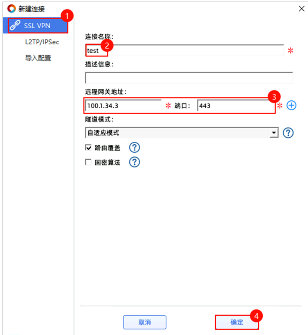
图6-27 配置 SSL VPN 连接参数
