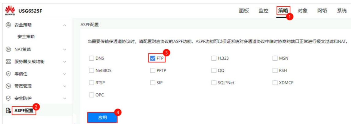
图6-15 DC-FW 设备 FTP 服务 ASPF 功能配置
