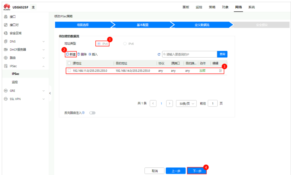
图6-5 IPsec 策略基础参数配置
