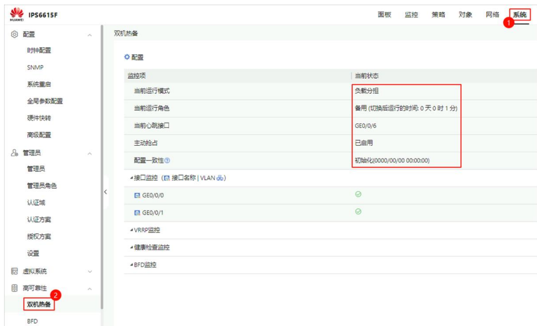
图2-29 IPS2 双机热备配置
