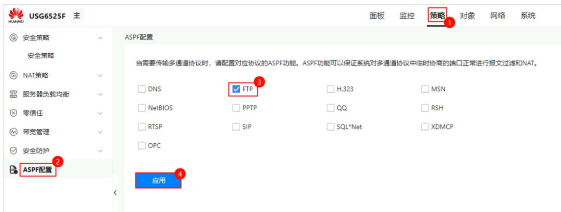
图6-13 HQ-FW1 设备 FTP 服务 ASPF 功能配置
