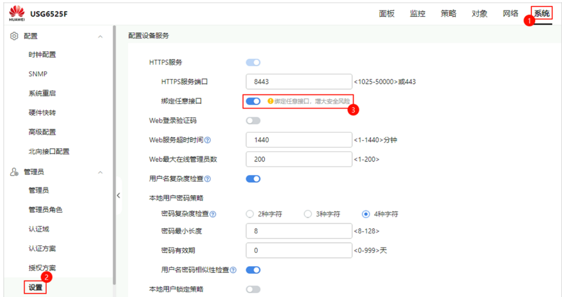
图4-6 配置 Branch-FW 设备 HTTPS 服务的绑定接口
