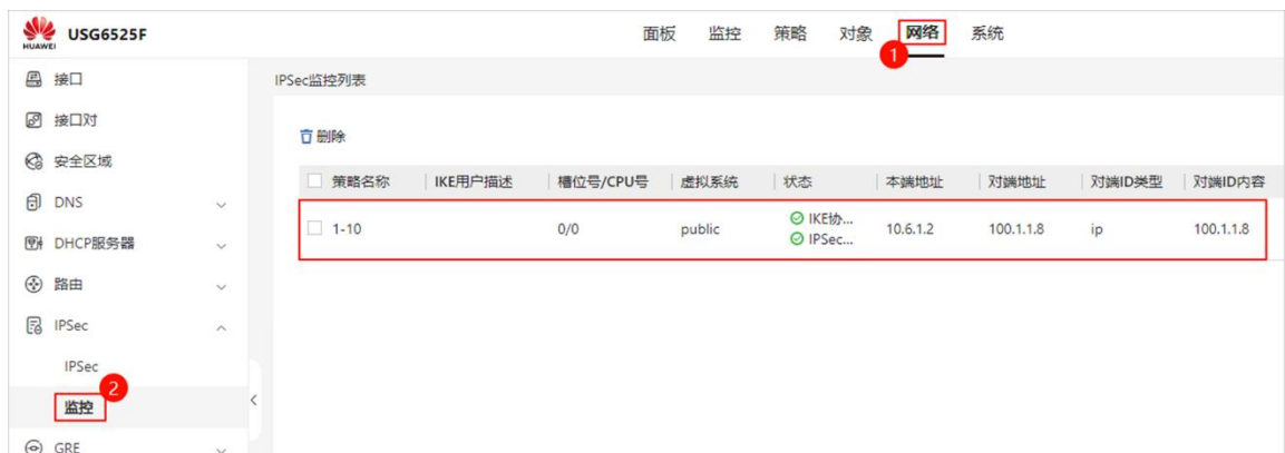
图6-39 FW2 设备 IPsec VPN 隧道信息
