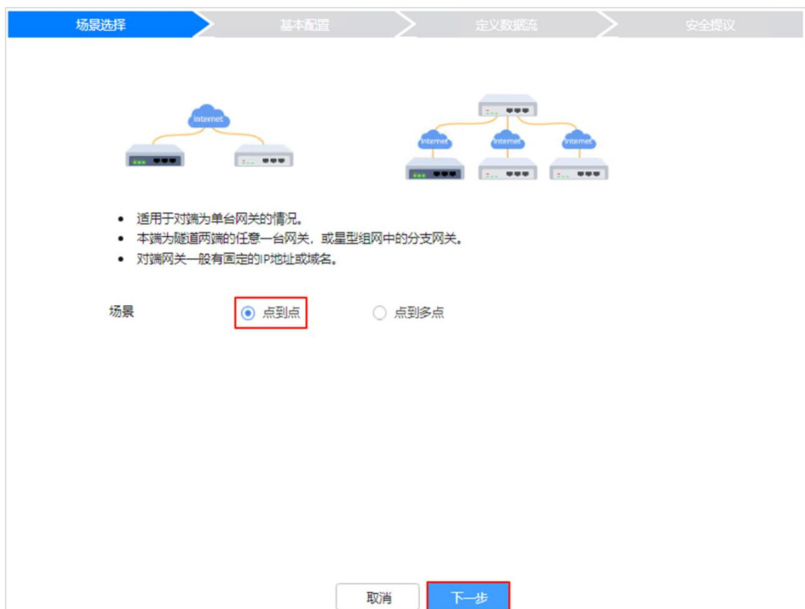
图6-15 进入 FW2 设备 IPsec 策略配置界面
