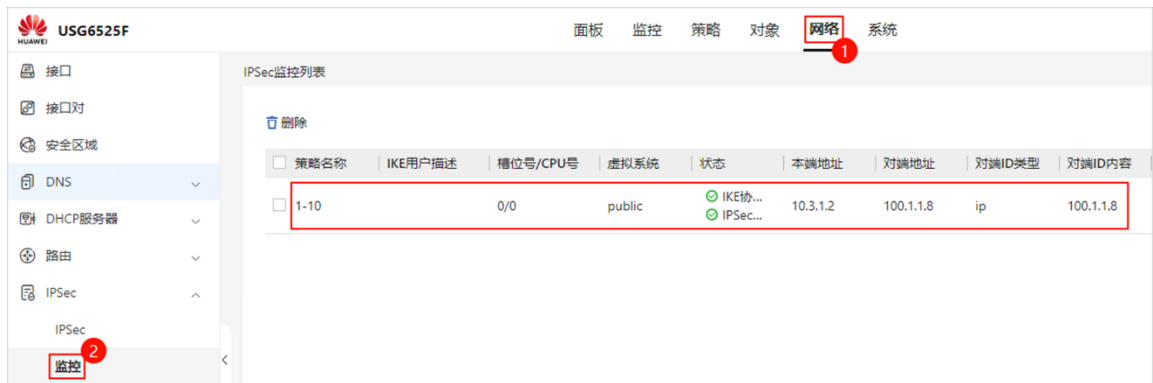
图6-38 FW1 设备 IPsec VPN 隧道信息
