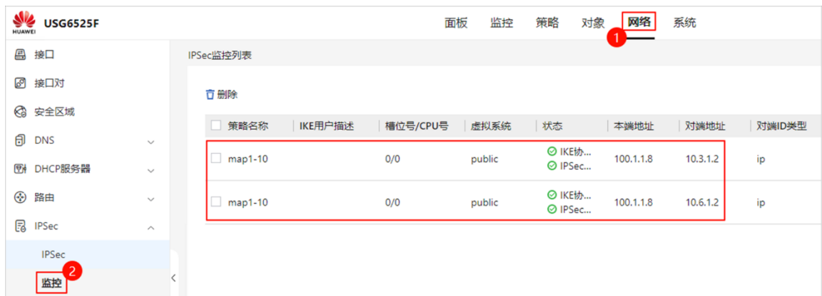
图6-40 FW3 设备 IPsec VPN 隧道信息
