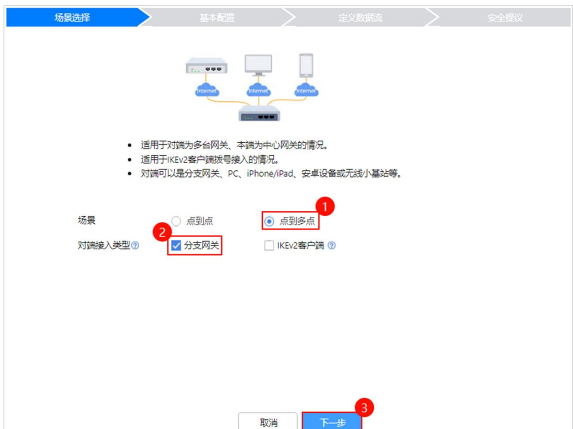
图6-20 进入 FW3 设备 IPsec 策略配置界面
