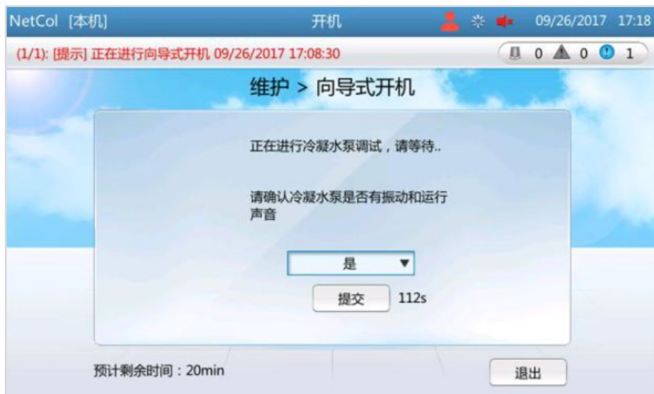
图2-38 调试冷凝水泵
