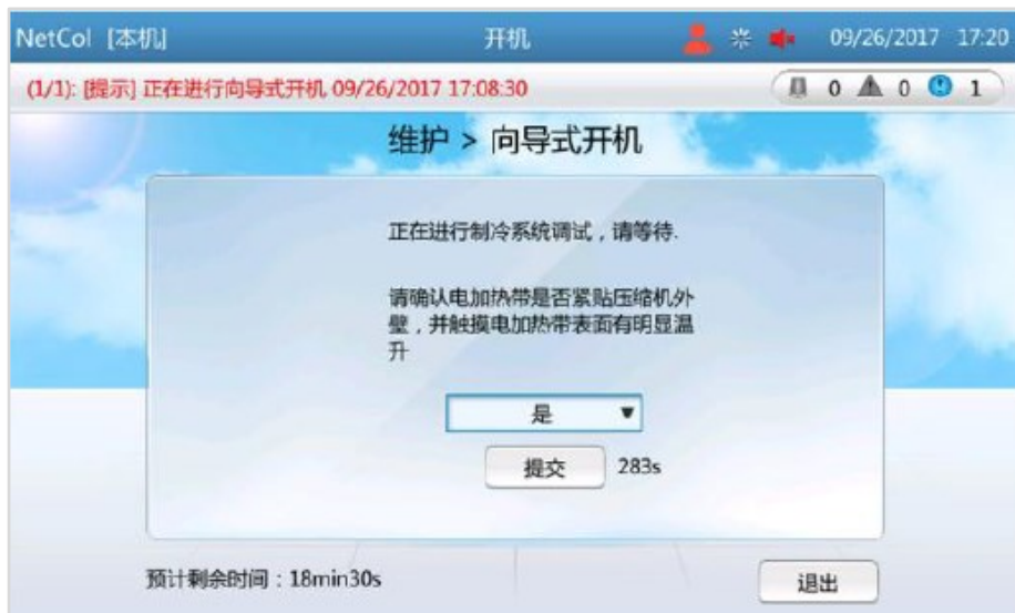
图2-39 调试制冷系统
